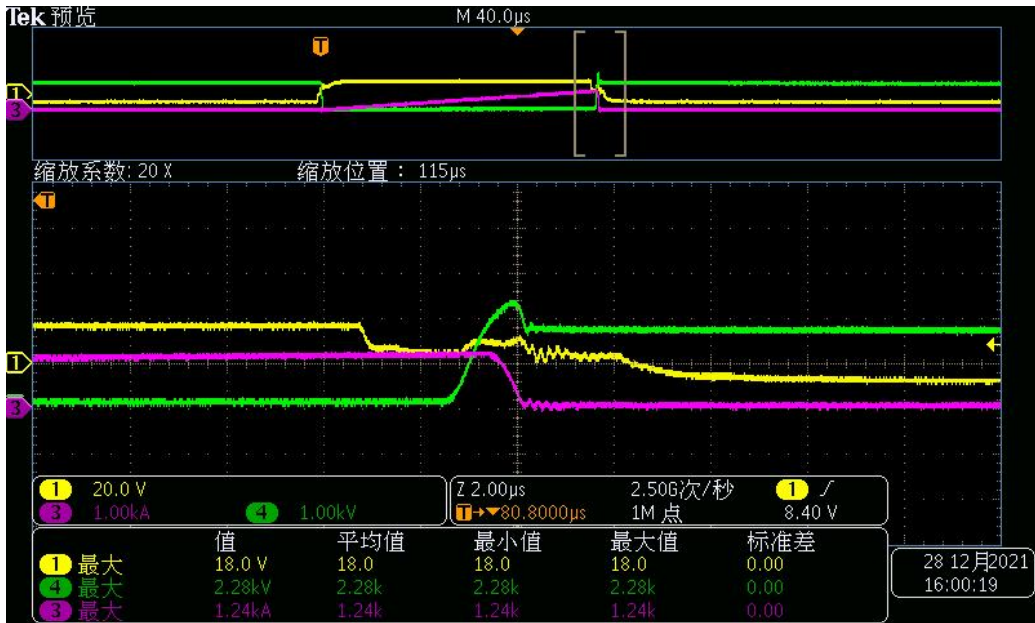
图 8- 2 FZ1500R33HE3 在母线电压 1600V，集电极电流 1200A 条件下数控有源钳位动作情况
